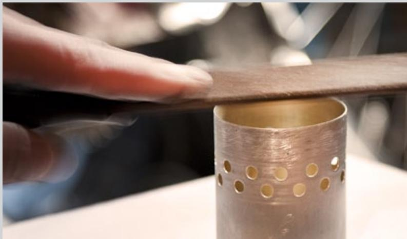
**7.** Oberkante feilen und entkraten. Endfinish durch Schleifen und z.B. mit Stahlwolle verfeinern.
