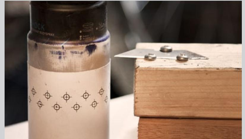
**6.** Teppichmesser-Klinge auf ein Holz mit 60mm Höhe schrauben. Die Dose so lange daran entlang drehen bis sie „durch“ ist.
